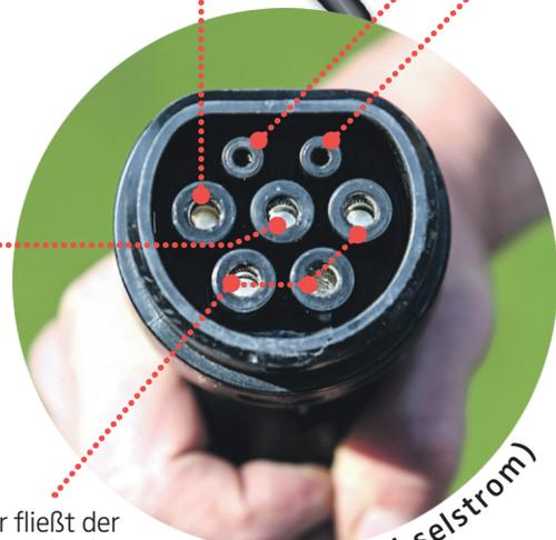
Hier fließt der Strom (Wechselstrom, 3-Phasen L1, L2 und L3). Bei 1-Phasen-Ladung ist nur L1 aktiv.
